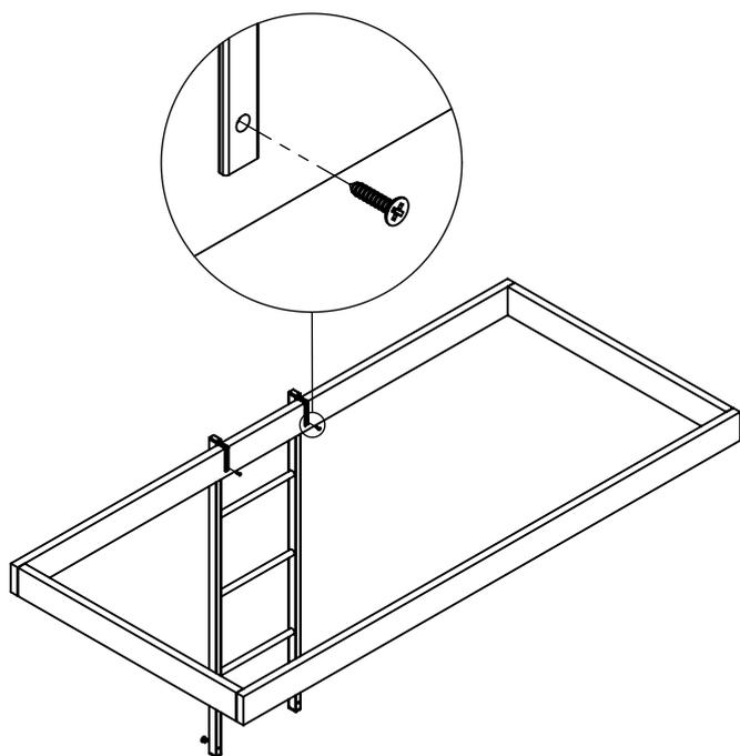
Posicione a Escada(A) no local de instalação e fixe-a utilizando os parafusos(C).
