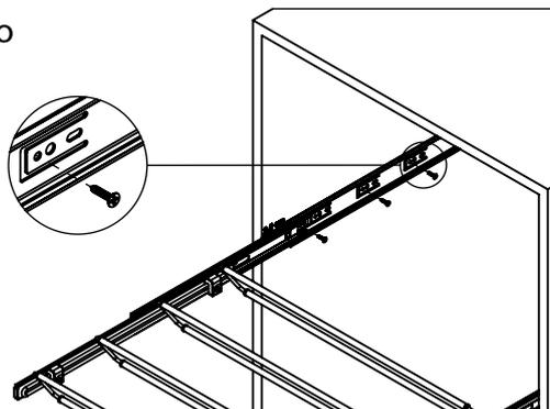
Abra as corredeiras até o final e fixe-as no móvel utilizando os parafusos(B).
