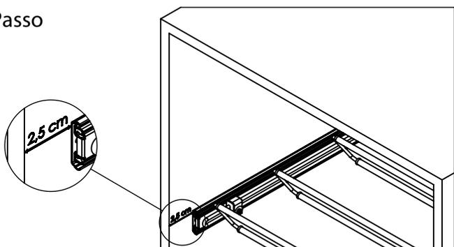
Posicione o calceiro(A) no local de instalação mantendo um afastamento mínimo de 2,5cm da frente do móvel. Extenda-o até alcançar as laterais do móvel.
