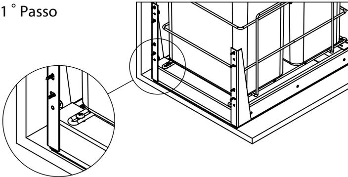
Posicione a Lixeira(A) no local de instalação, alinhando a frente do quadro com a frente do móvel.
