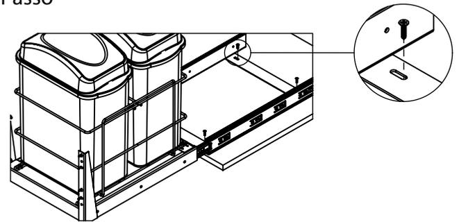
Extenda a Lixeira(A) para fora do móvel e fixe-o utilizando os parafusos(B).
