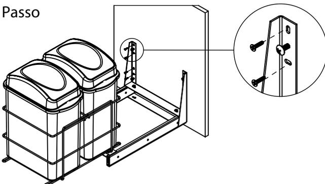
Insira os Parafusos(C) na chapa e os Parafusos(B) no móvel, sem apertar por completo. Regule utilizando os Parafusos(C) e fixe a Lixeira(A) ao tampo do móvel apertando os Parafusos(B).
