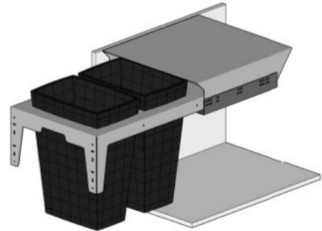
Extenda a Lixeira(A) para fora do móvel e fixe-a utilizando os parafusos(B).
