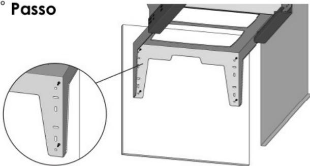
Insira os Parafusos(C) na chapa e os Parafusos(B) no móvel, sem apertar por completo. Regule utilizando os Parafusos(C) e fixe a Lixeira(A) ao tampo do móvel apertando os Parafusos(B).
