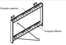
Monte as hastes(B) no quadro(A) encaixando primeiramente a haste(B) na furação inferior.
