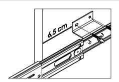
Posicione o quadro (A) no local de instalação, mantendo um afastamento mínimo de 6,5cm da frente do móvel.
