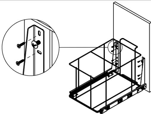
Fixe a frente do conjunto ao tampo do móvel utilizando os Parafusos(D) e regule utilizando os parafusos(E).
