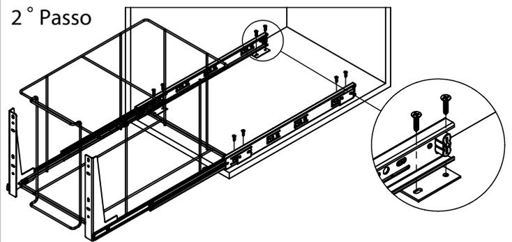
Posicione o conjunto alinhando a frente das Torres(C) com a frente do móvel, puxe o conjunto para fora e fixe-o utilizando os Parafusos(D).
