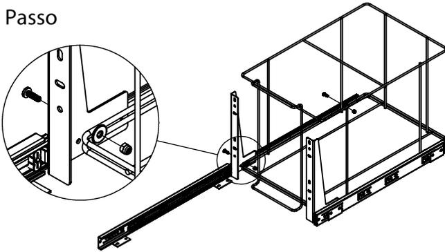
Alinhe a frente da Torre(C) com a frente do Aramado(B) e fixe-os utilizando os Parafusos(F), Arruelas(G) e Porcas(H).
