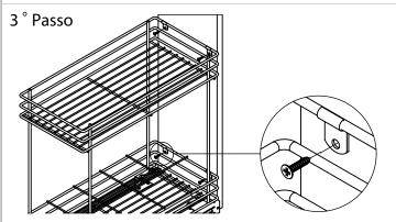
Obs: Se desejar fixar o Porta Garrafas(A) ao tampo do móvel, utilize a Chapa de Fixação(B) e os parafusos(C).
