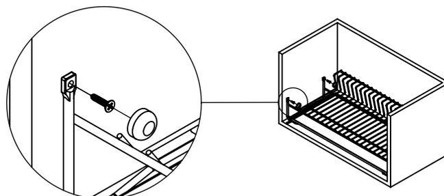
Fixe-o utilizando os parafusos(B) e finalize colocando os acabamentos(C).
