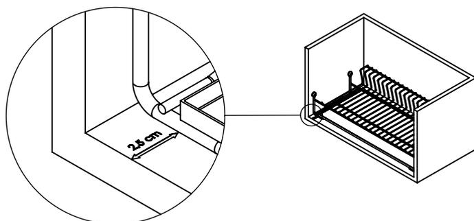
Posicione o Porta-Pratos(A) no local de instalação, mantendo um afastamento mínimo de 2,5 cm da frente do móvel.
