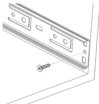
Fixe a corrediça(B) na lateral móvel, alinhando a frente da peça com a frente do movel. Fixe utilizando os parafusos(G)
