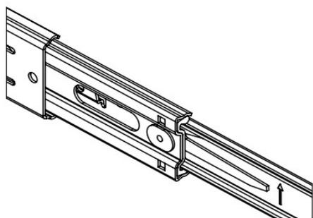
Desmonte a corrediça(B) utilizando a alavanca de separação.
