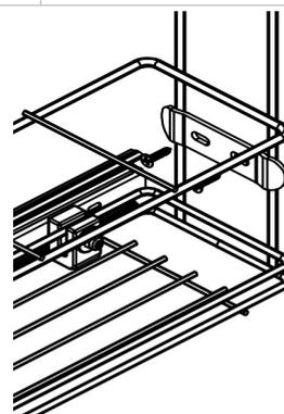
Para móvel com porta, fixe o conjunto utilizando a chapa de fixação (H) com os parafusos (G).
