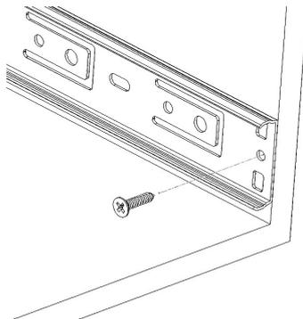
Fixe a corrediça(B) na lateral móvel, alinhando a frente da peça com a frente do movel. Fixe utilizando os parafusos(F)
