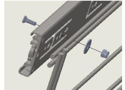
Posicione a corrediça no garrafeira, utilizando o parafuso(C) no aramado(A), fixandocom arruela(E) e porca(D).
