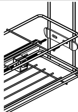
Para móvel com porta, fixe o conjunto utilizando a chapa de fixação (G) com os parafusos (F).
