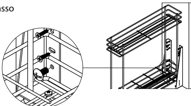
Insira os Parafusos(C) na chapa e os Parafusos(B) no móvel, sem apertar por completo. Regule utilizando os Parafusos(C) e fixe o Porta Garrafas(A) ao tampo do móvel apertando os Parafusos(B).
