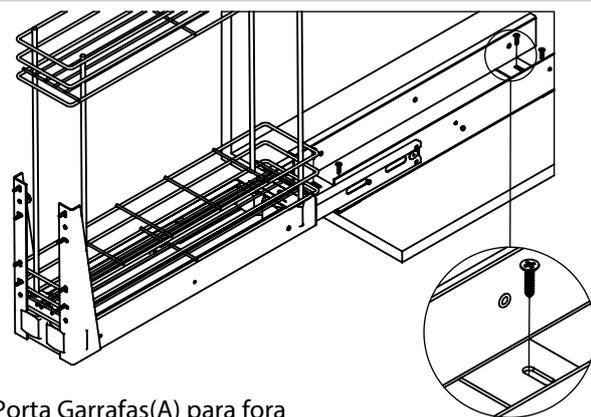
Extenda o Porta Garrafas(A) para fora do móvel e fixe-o utilizando os parafusos(B).
