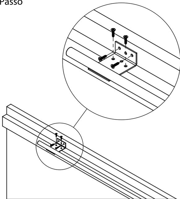
Fixe o guia no móvel de acordo com a medida desejada, utilizando os parafusos(F), na vertical ou horizontal.
