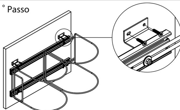
Fixe o conjunto na lateral do móvel usando os Parafusos(E).
